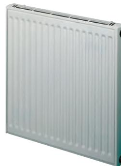
Элегантные дизайны. Универсальные модели с шестью отверстиями позволяют выполнить подключение снизу, по диагонали или сбоку. Радиаторы с закругленными формами в верхней части обеспечивают дополнительную безопасность. Широкий выбор типоразмеров: 6 по высоте, 6 по ширине и 18 по длине. Рабочее давление воды в системе – не более 10 Бар.
