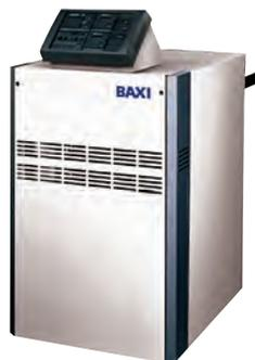
Секционный теплообменник из высокопластичного чугуна с профильными ребрами имеет большую поверхность теплообмена. Котел можно укомплектовать двумя вариантами горелки: стандартная атмосферная горелка (SE) и высокочистая атмосферная горелка (LE). Широкий модельный ряд: 17 различных моделей от 48 до 348 кВт. Два варианта газовых блоков под низкое (20 мБар) и среднее (300 мБар) давление.
